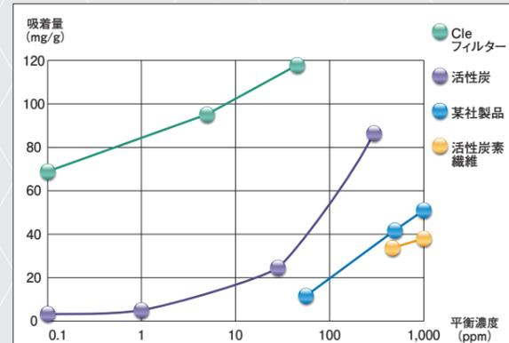
2 新素材ハニカム構造の「Cleフィルター」でアルデヒド類\*もしっかりキャッチ。「Cleフィルター」には多彩な種類があり、臭いの種類や目的に応じてお選びいただけます。
